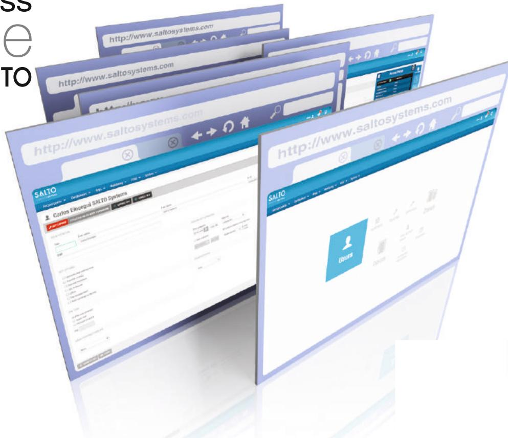
Программное обеспечение SALTO ProAccess SPACE – ядро Системы Контроля и Управления Доступом (СКУД). Оно позволяет задействовать весь потенциал возможностей, заложенных в наше оборудование и предоставляет Вам гибкий и удобный инструмент управления СКУД всего здания, вне зависимости от его размера. ProAccess SPACE может управлять тысячами дверей, миллионами пользователей, при любой пропорции он-лайн/офф-лайн точек доступа.
